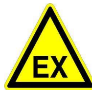
Figuur 1: Markering van locatie waar een ontplofbare atmosfeer kan voorkomen
