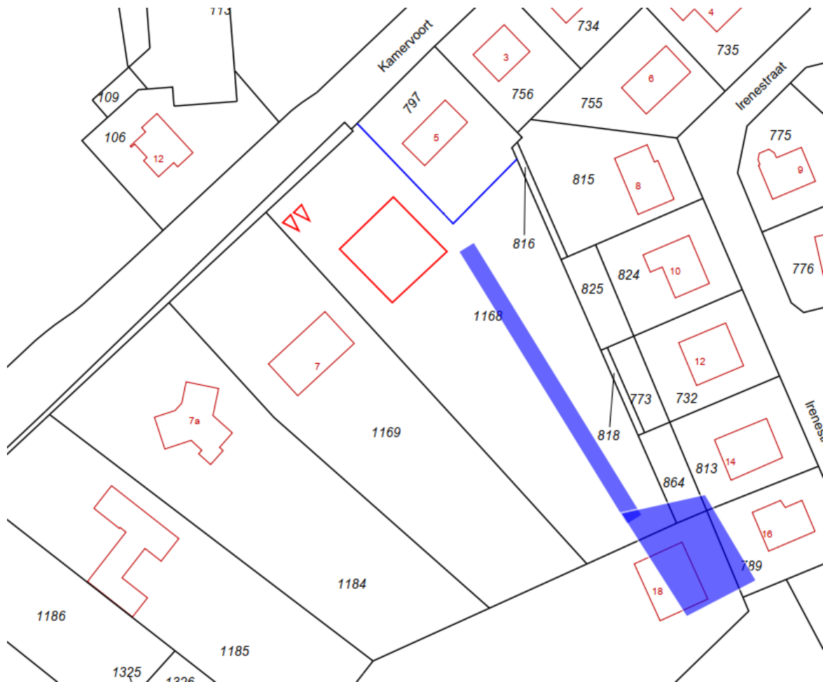
Ligging gedempte watergang en voormalige zuidelijk gelegen waterpartij
