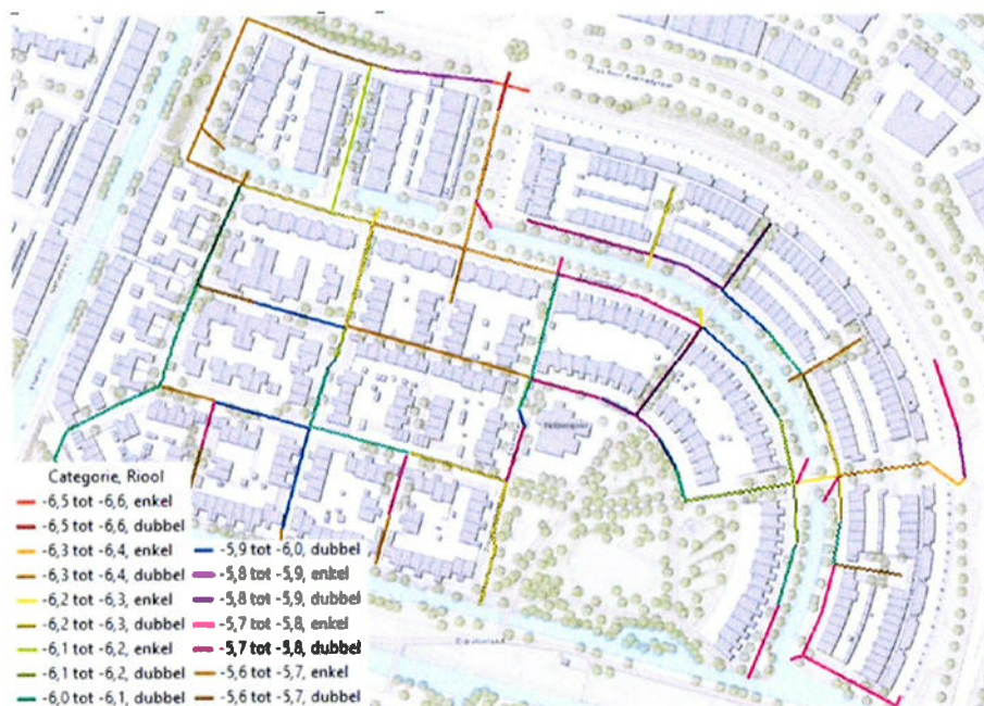
Figuur 3.1.1: Ligging te vervangen rioolstelsel met rioolputten
