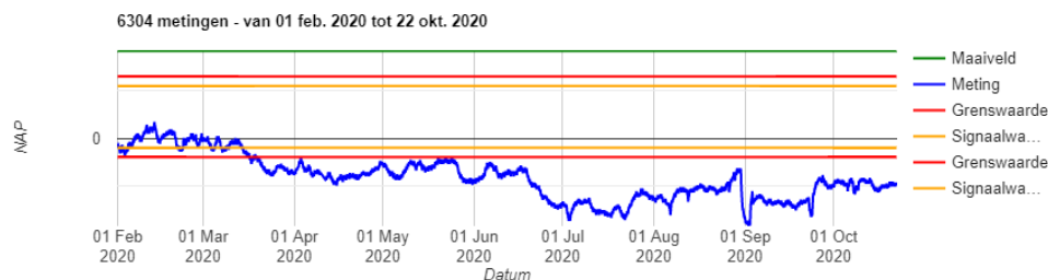
Figuur 8 diepe freatische grondwaterstand ter plaatse van Rozenburg (Iependaal)
