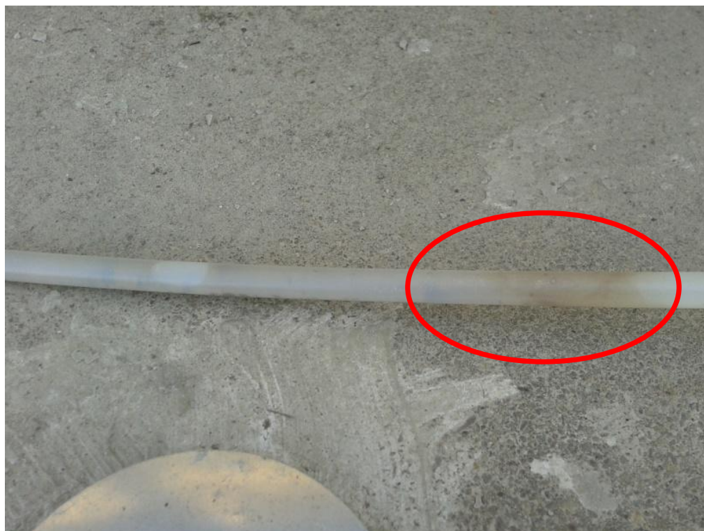
Figuur 1 puur product in onttrekkingslang
