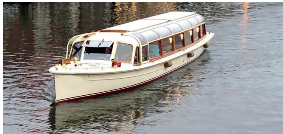
De opbouw van deze klassieke rondvaartboot is zorgvuldig vormgegeven en passend bij het type vaartuig. Voor- en achterdek zijn voldoende vrij.
