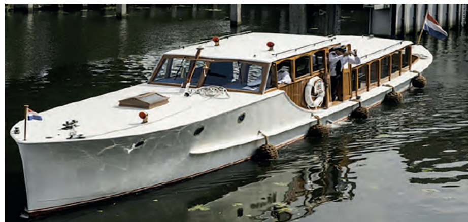
De romp van dit salonvaartuig van het type bakdekker heeft een mooi gelijnde romp met een uitgesproken voor- en achtersteven.
