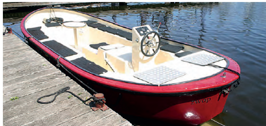
De romp van deze rondvaartboot heeft geen zeeg en mist sierlijke lijnen en rondingen.
