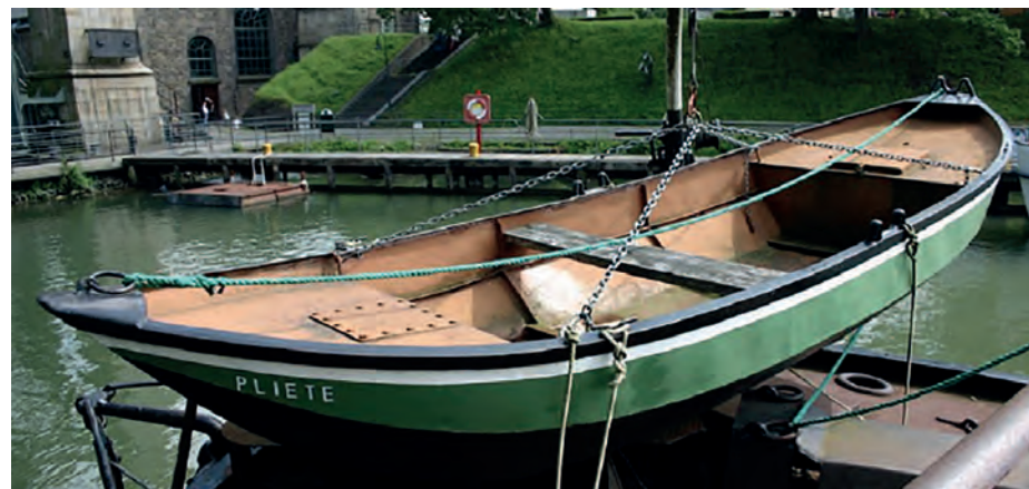
De romp van deze bijboot heeft een duidelijke zeeg, sierlijke lijnen en rondingen en is symmetrisch over de lengteas
