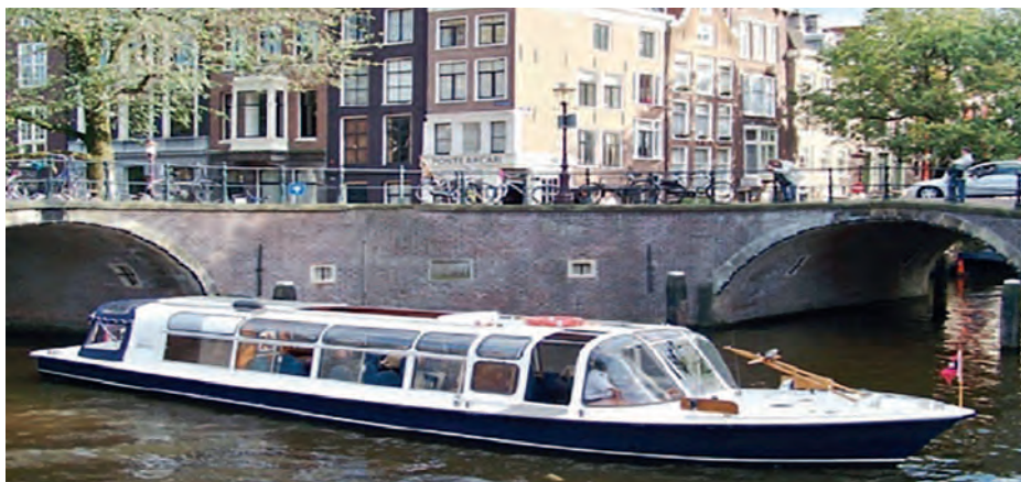
De romp van deze relatief korte rondvaartboot van het Amsterdamse grachtentype is mooi gelijnd in een juiste verhouding en heeft een spitse steven.
