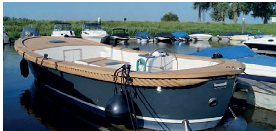
De romp van deze nieuwgebouwde sloep heeft geen zeeg en mist sierlijke lijnen en rondingen.
