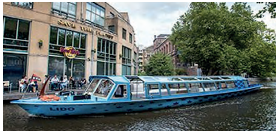
De romp van deze rondvaartboot van het Amsterdamse grachtentype is mooi gelijnd, heeft een oplopende steven, een bescheiden hoogte en breedte en laat het voor- en achterdek vrij.
