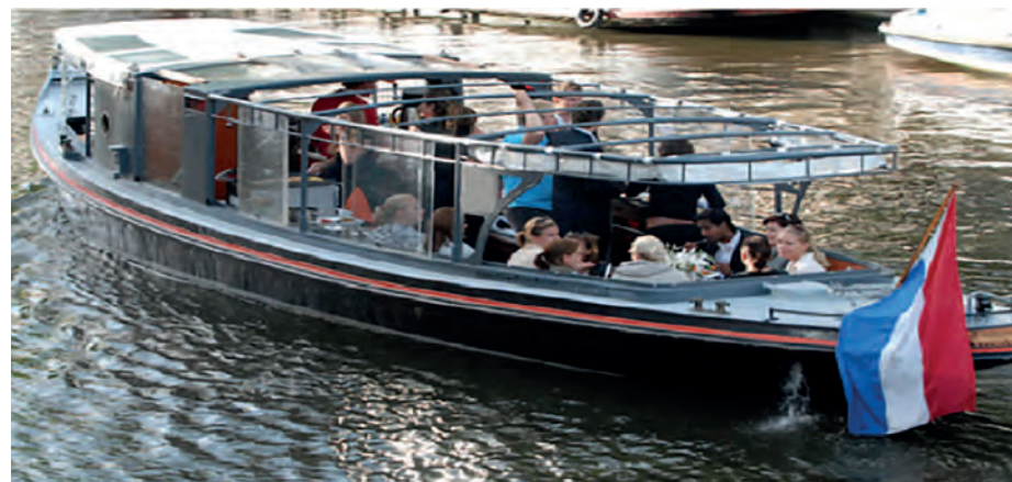
De overkapping van dit salonvaartuig heeft wegneembare raampartijen van hard kunststof.
