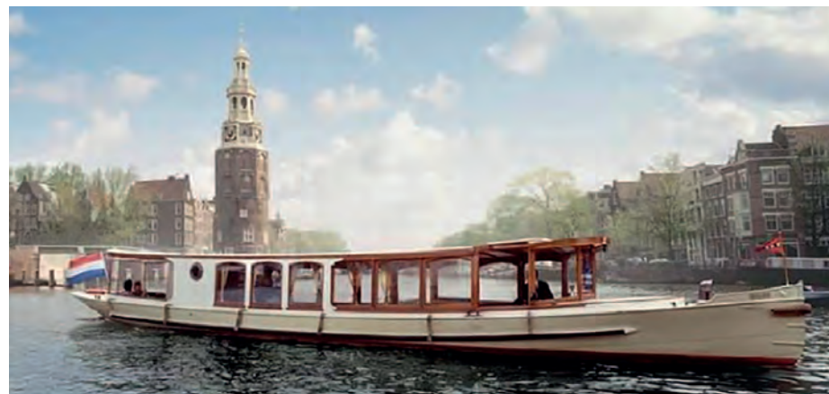
De romp van dit salonvaartuig heeft een duidelijke zeeg en is mooi gelijnd met een uitgesproken voor- en achtersteven.
