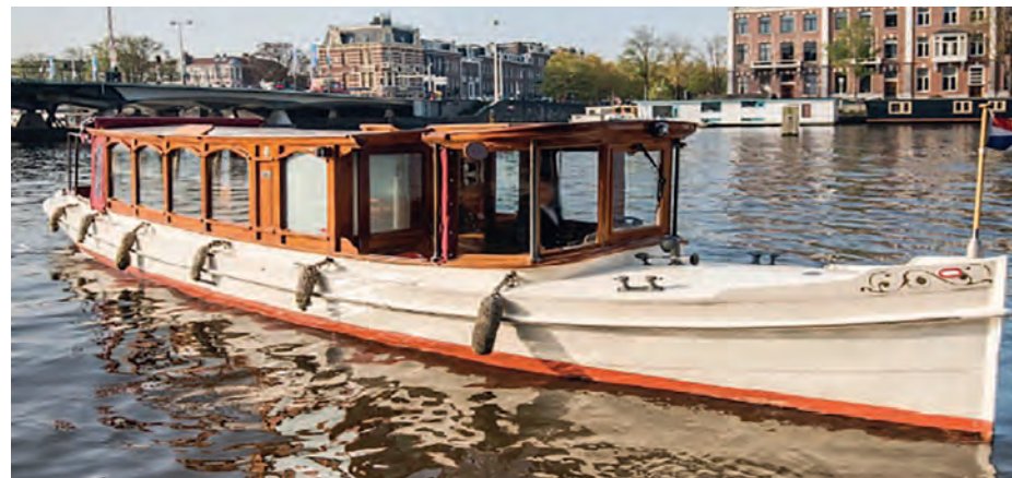
Dit historische salonvaartuig heeft vele mooie nautische onderdelen en aantrekkelijke details; messing hoorn, messing kikkers en van hennep touw gevlochten fenders.
