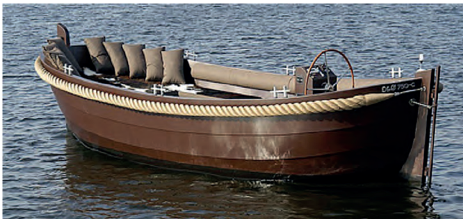
De romp van deze sloep heeft een duidelijke zeeg, sierlijke lijnen en rondingen én is overnaads gebouwd.
