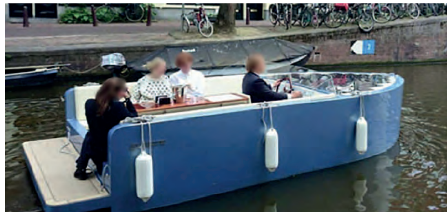
De romp van dit vaartuig heeft een zwemplatform en geen zeeg en mist sierlijke lijnen en rondingen.
