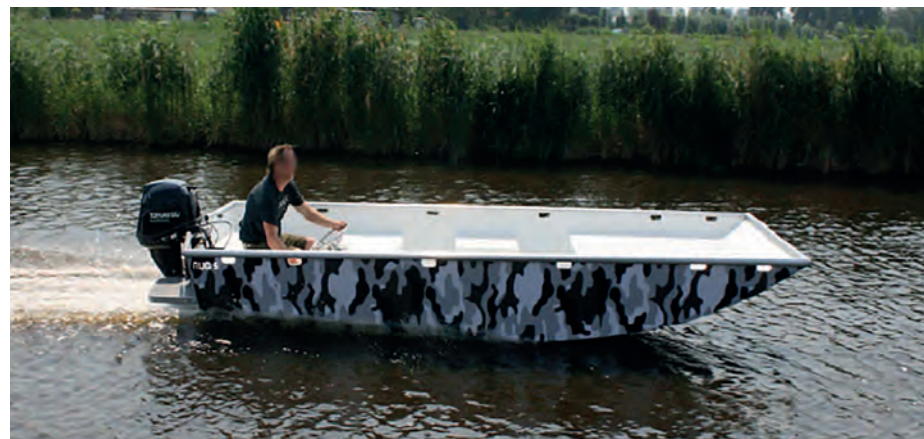
De romp van dit vaartuig heeft geen zeeg en mist sierlijke lijnen en rondingen.
