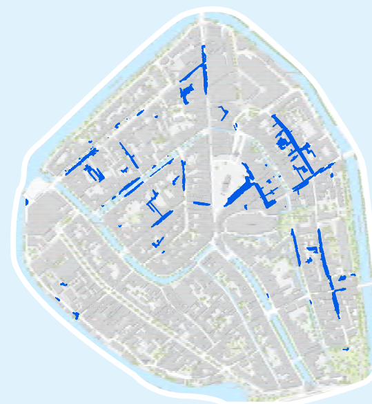
water op straat 2050 bij alleen rioolvervanging
