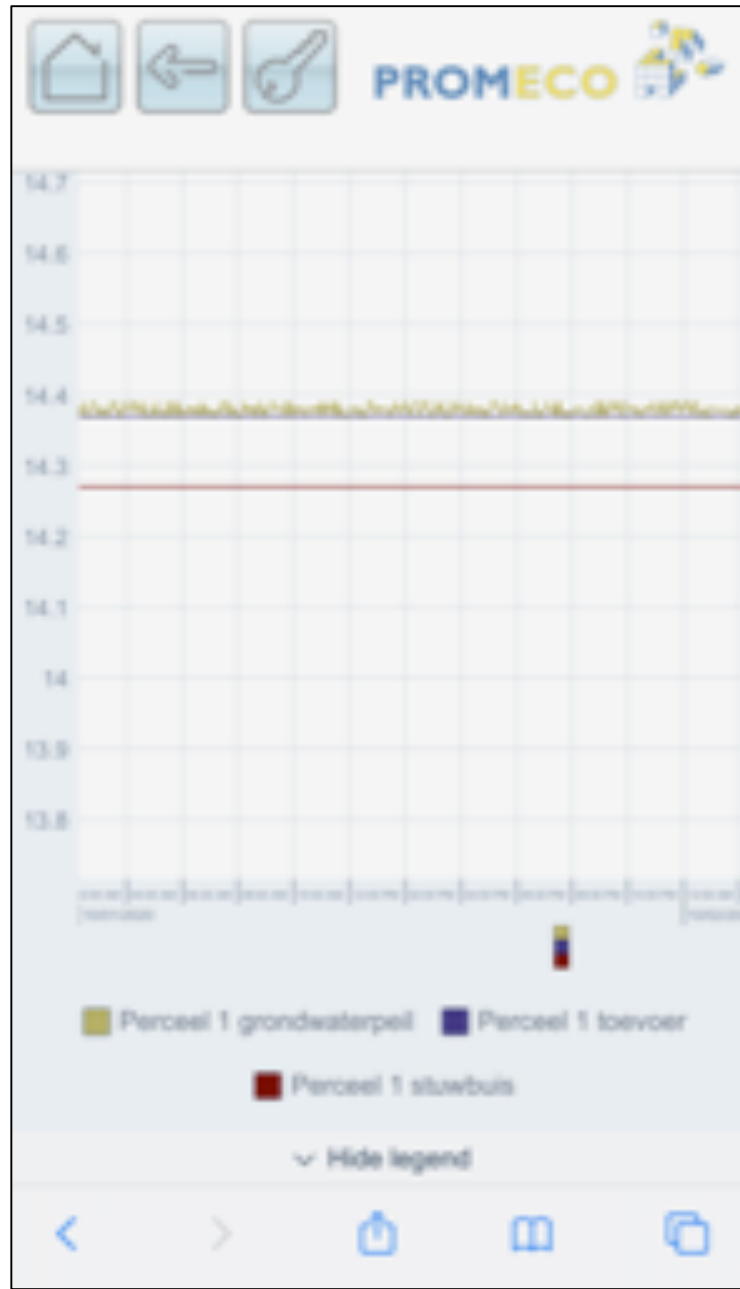
voorbeeld grafiek grondwaterpeil en instellingentoevoer en stuwbuis
