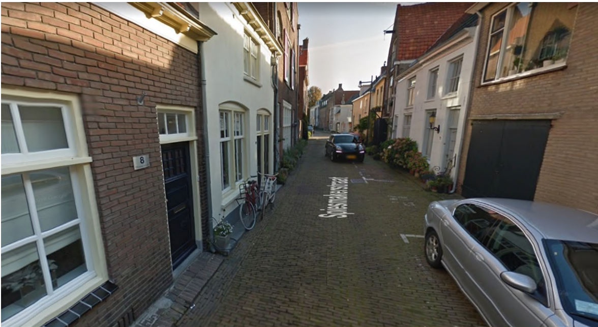
Afbeelding 6 Bij een gebrek aan ruimte is de inpassing van een volwaardige trottoir aan minimaal één straatzijde bovengeschild aan parkeercapaciteit (Zaltbommel, Spiesmakerstraat Google©)
