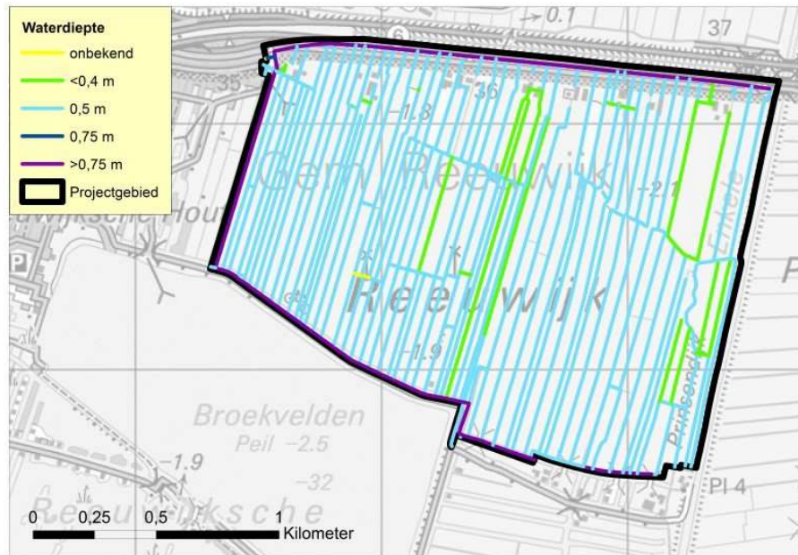
Figuur 3-5a. Diepte van de watergangen in Polder Abessinie
