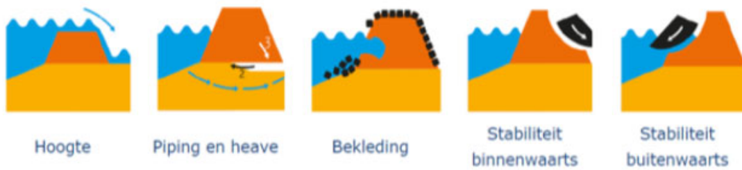
Figuur 0.1 Werking van de verschillende faalmechanismen
