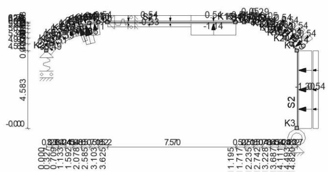
AFB. LASTEN B.G.20 WINDBELASTING VAN RECHTS + ONDERDRUK (2E CPE) (2E CORR. FACTOR)
