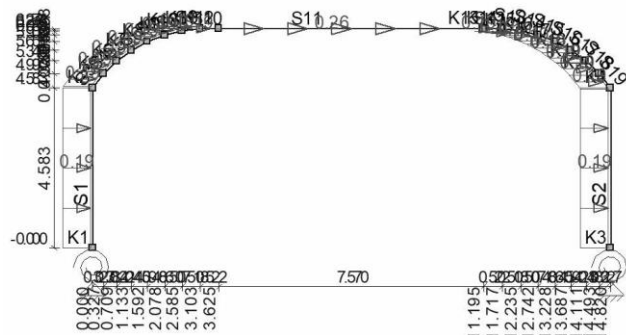
AFB. LASTEN B.G.25 KNIKLENGTE (ASSYMETRISCH)
