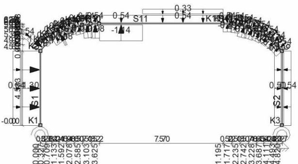
AFB. LASTEN B.G.11 WINDBELASTING VAN LINKS + ONDERDRUK (2E CORR. FACTOR)
