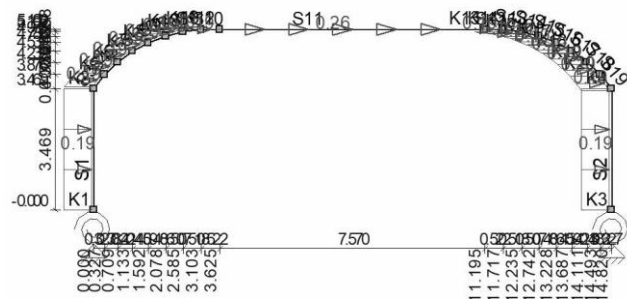
AFB. LASTEN B.G.25 KNIKLINGTE (ASSYMETRISCH)
