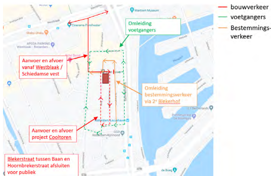
Figuur 4.4: Omleiding route voetgangers.
