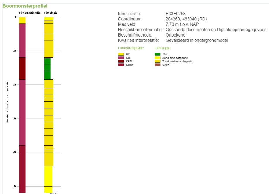
Afbeelding 2.1: Boorprofiel boring B33E0268
