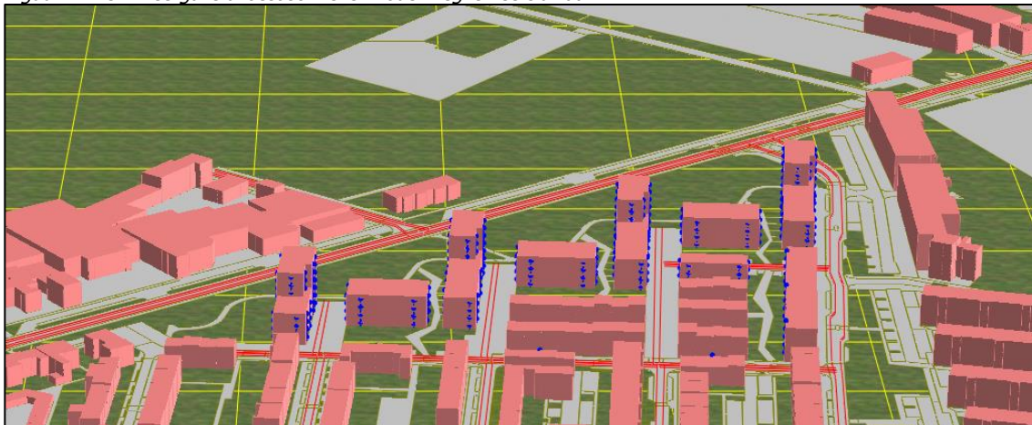
Figuur 4.1: 3D-weergave akoestisch rekenmodel wegverkeerslawaaï
