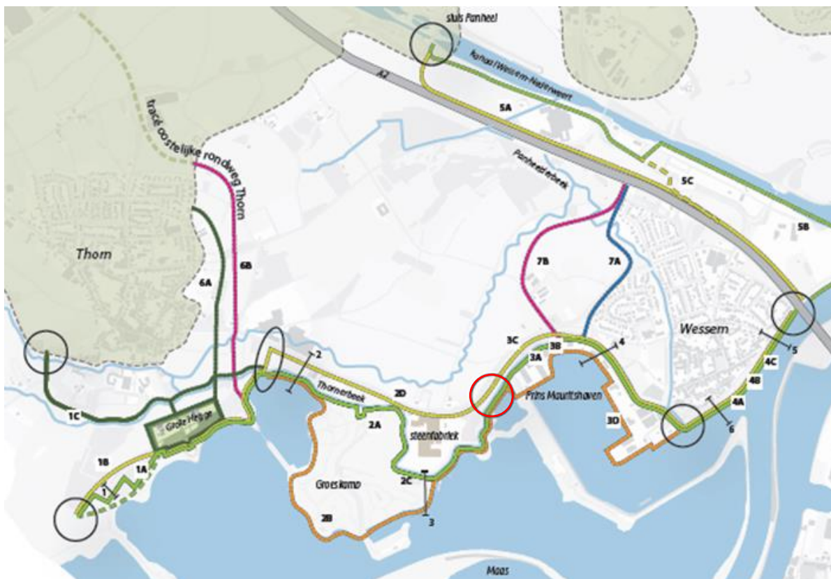
Figuur 2-22: De dijktracés waaronder de tracés 6A, 6B, 7A en 7B die de oost- en westgrenzen vormen van het retentiebekken. De instroom voorziening voor de hydraulische berekeningen in varianten 2 en 3 is weergegeven binnen de rode cirkel.
