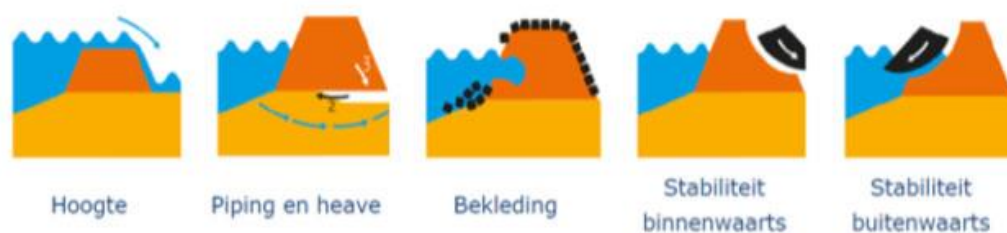
Figuur 0.1 Werking van de verschillende faalmechanismen
