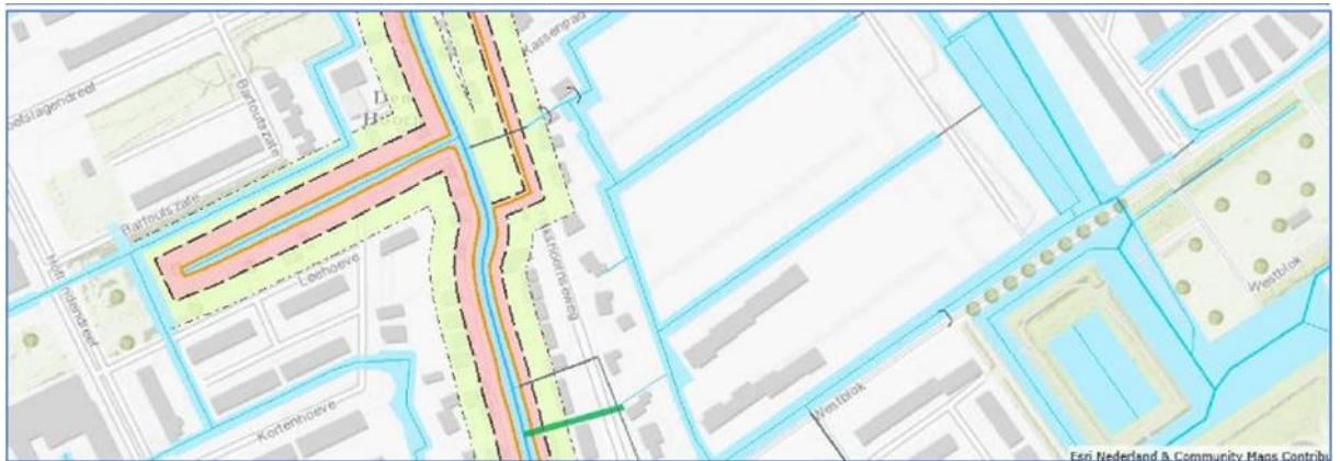
Figuur 3-1 Legger Waterkering, rood waterstaatswerk, groen beschermingszone
