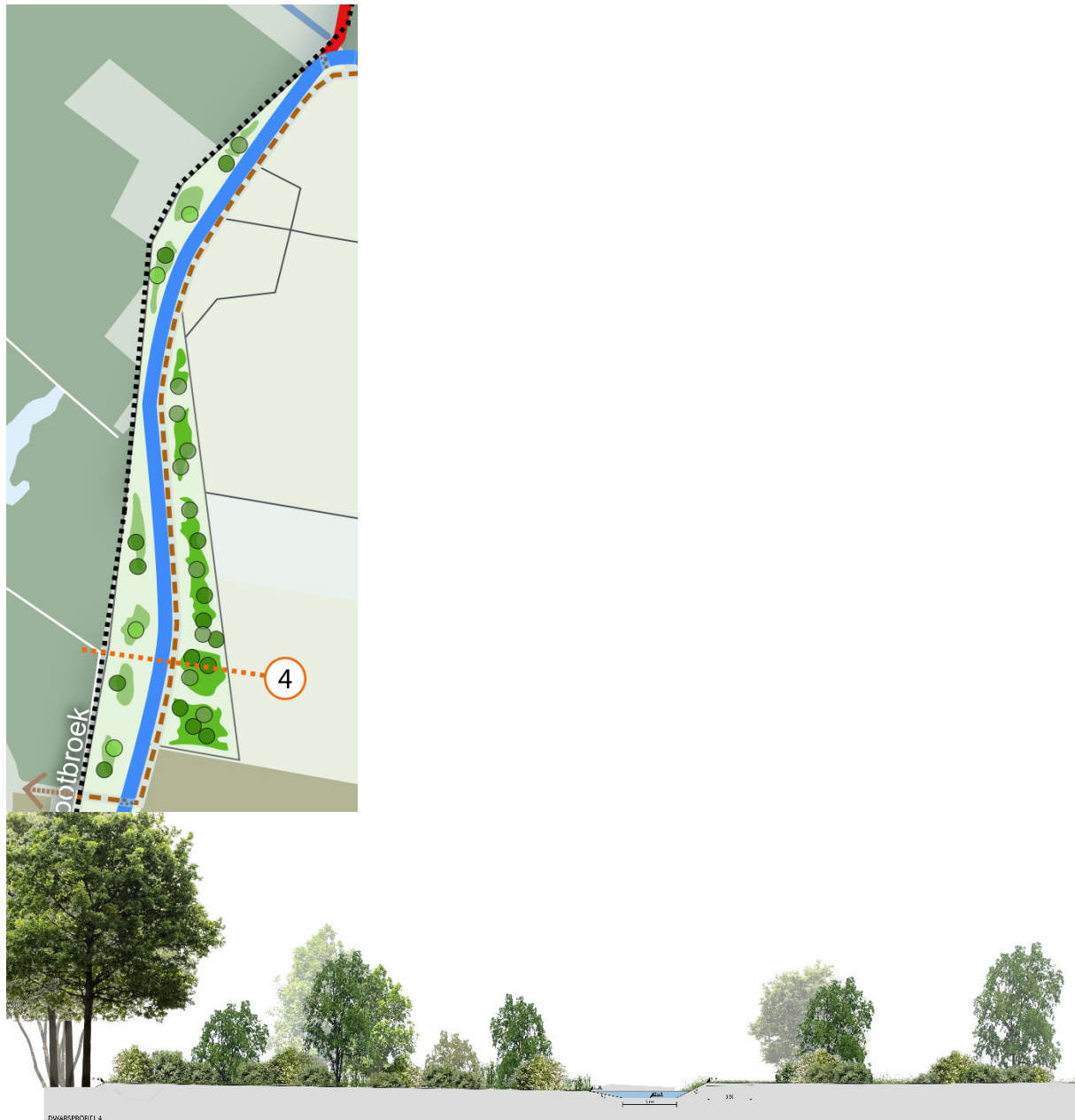
Figuur 2-6 Ligging omgelegde Lollebeek en dwarsprofiel ten oosten van de Castenrayse Vennen
