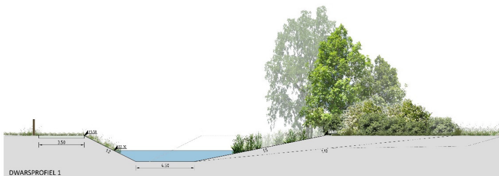
Figuur 2-2 Bovenstroomse ligging en dwarsprofiel Lollebeek
