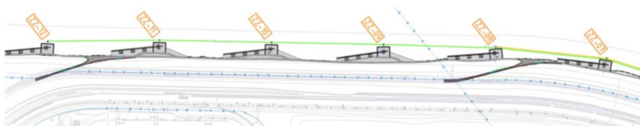
Figuur 21 Duinovergangen tussen windmolen ZZ-07 en ZZ-08 en tussen ZZ-11 en ZZ-12 (uitsnede van BG8375-RHD-ZZ-XX-DR-C-0004)
