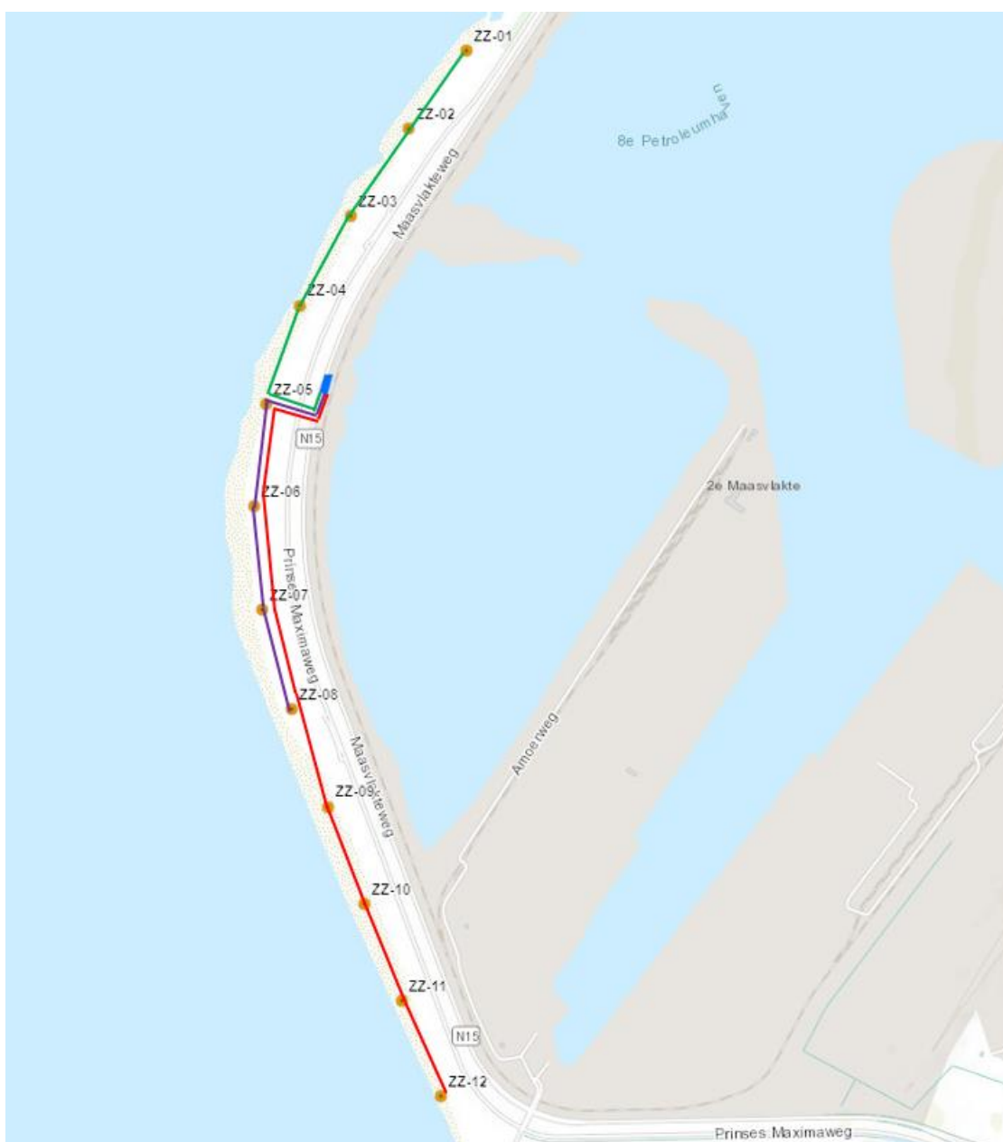
Figuur 25. Parkbekabeling van de windturbines op de zachte zeewering.
