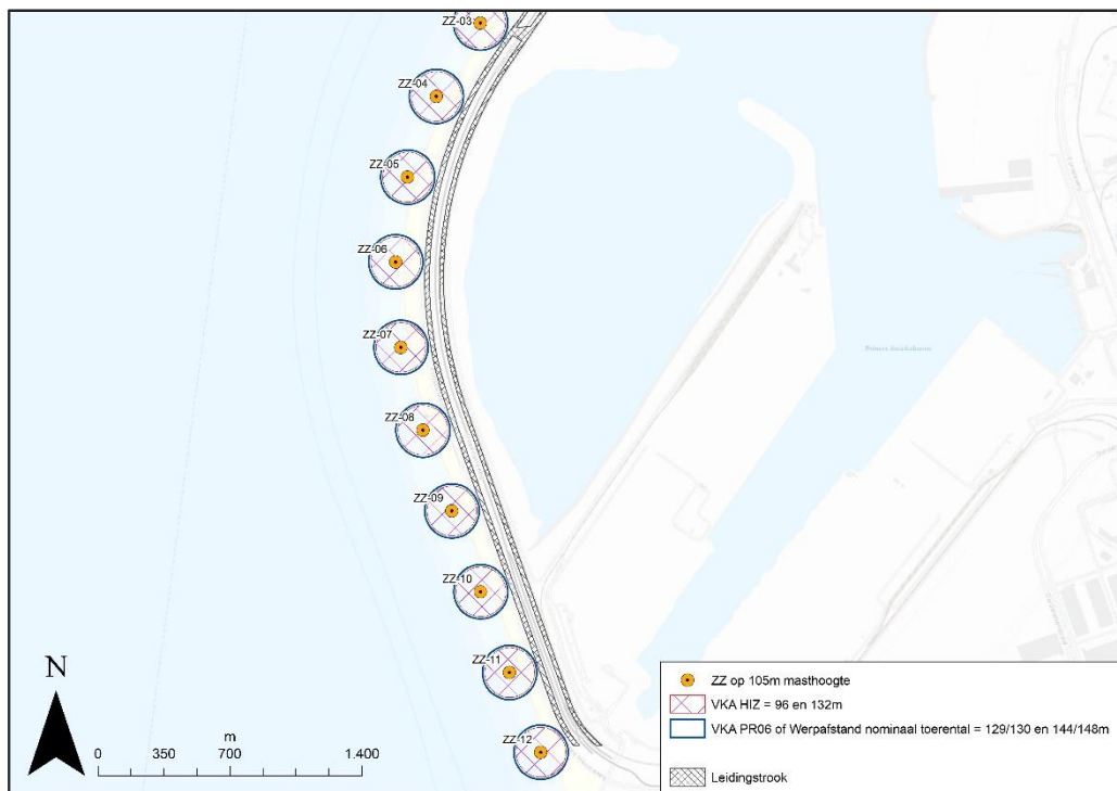
Figuur 5.7 Weergave buisleidingstrook i.r.t. windpark deelgebied Zuid
