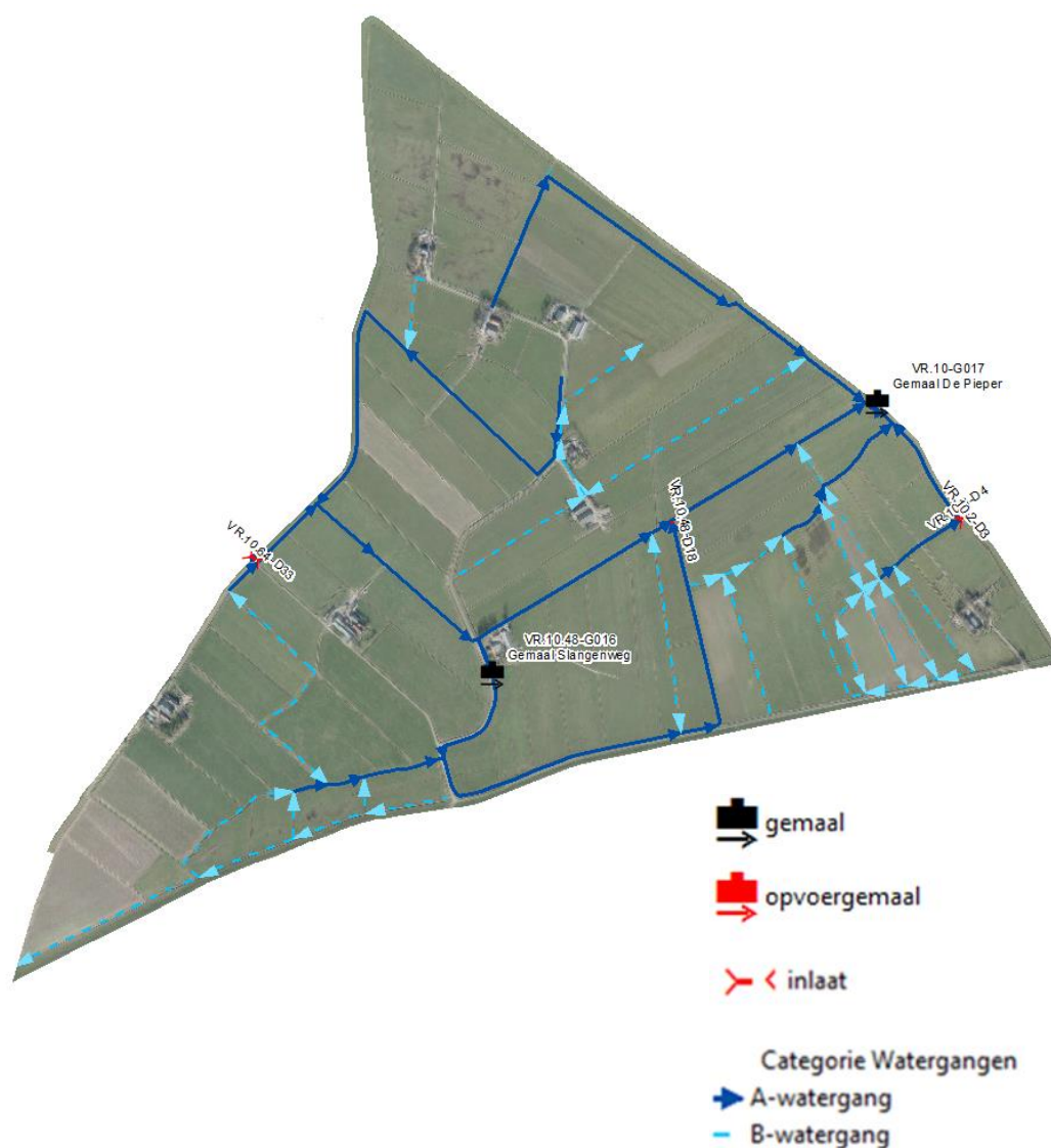
FIGUUR 6 OPPERVLAKTEWATERSYSTEEM POLDER DE PIEPER
