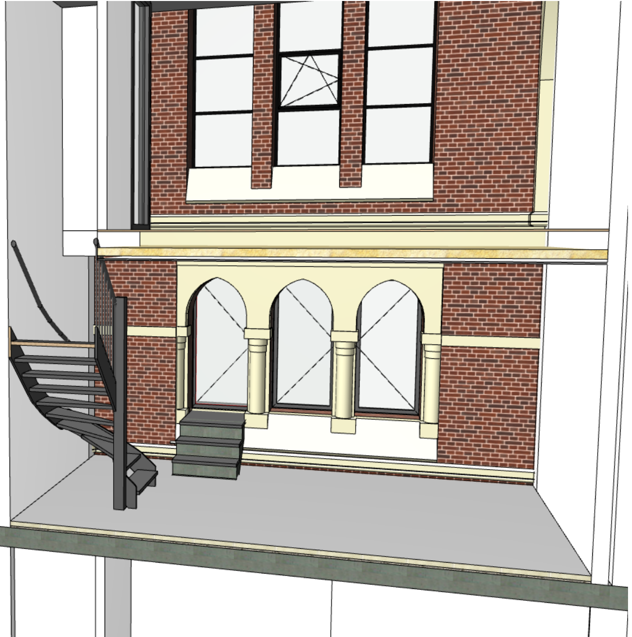
Trap conform Bouwbesluit, niet gewenst vanuit monumentaal oogpunt
