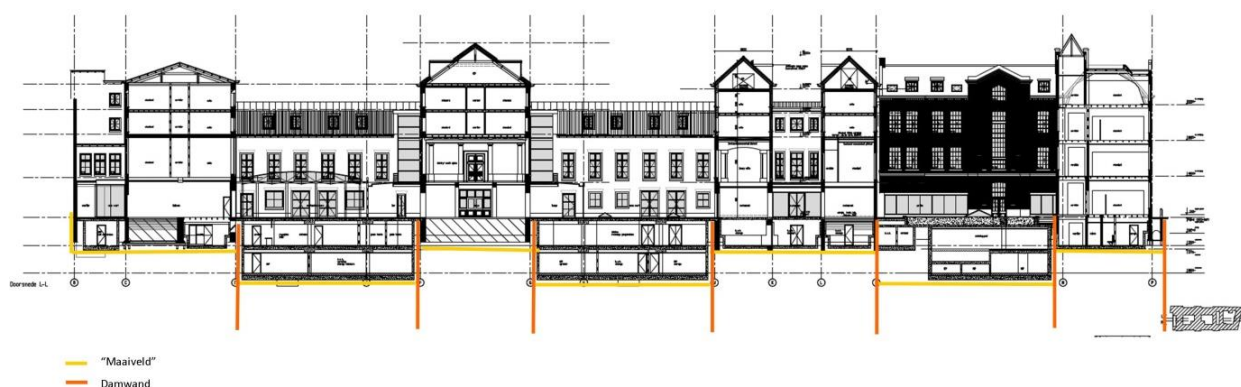
Figuur 5-6 doorsnede 3 bestaande bebouwing met nieuwe kelder, met schematisering van de damwanden
