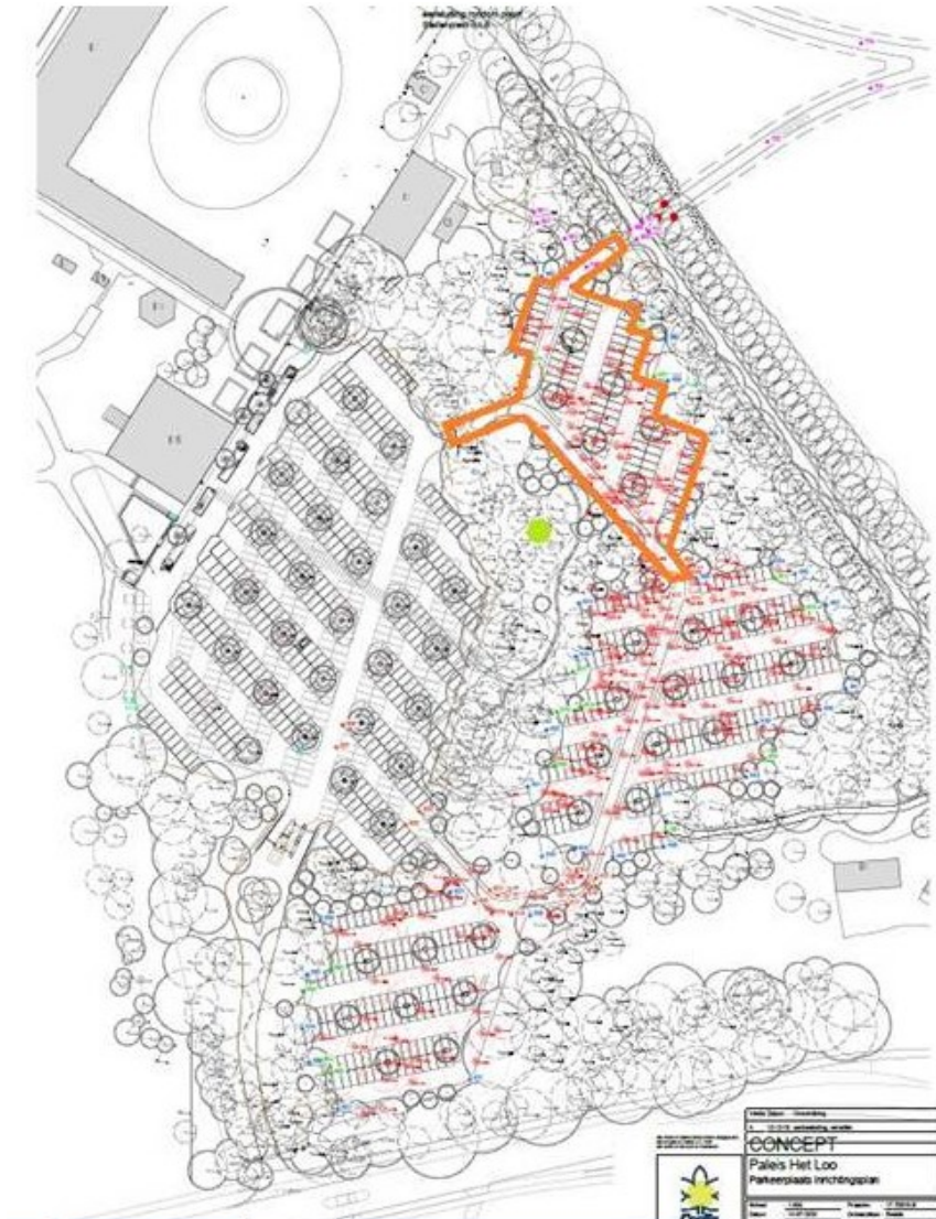
Figuur 3 Ontwerp bosparkeerplaatsen. Links-midden is de huidige parkeerplaats. Rechtsboven het noordelijk deel van de bosparkeerplaats (oranje omlijnd) dat vanwege de 20 meterzone rondom de dassenburcht (groene stip) pas in het najaar van 2021 zal worden aangelegd.
