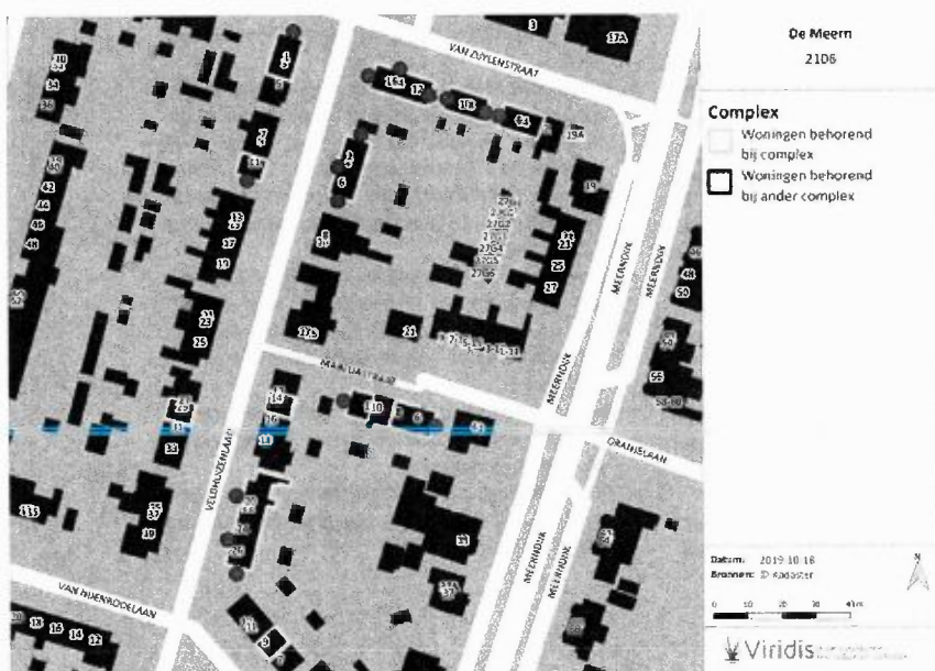
Figuur 2.2 | Overzichtskaat van complex 2106, overzicht posities 16 tijdelijke kasten. Steeds ophangen aan de kopse gevels, ter hoogte van de dakgoot of aan de voorzijde van de woningen direct onder de dakgoot.
