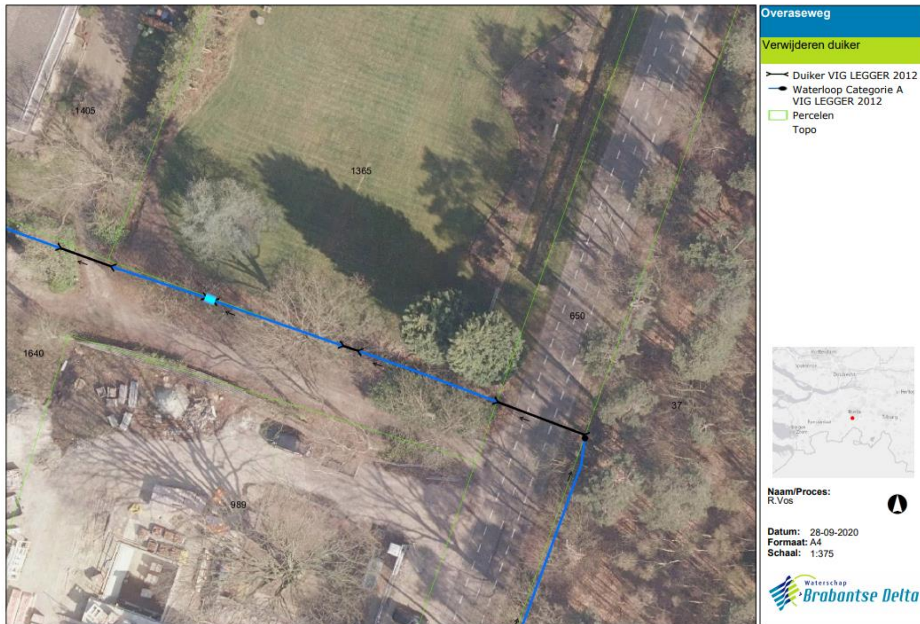
Figuur 4 Te verwijderen duiker KDU24163 (lichtblauw)
