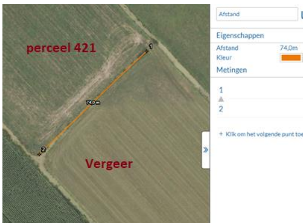
2b: Compensatie d.m.v. verbreden watergang met gemiddeld 50cm.(=74m x 1m = 74m)
