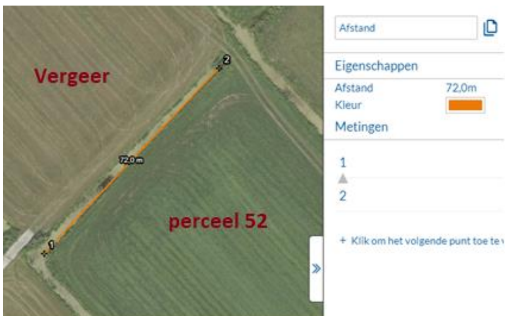
2c: Compensatie d.m.v. verbreden watergang met gemiddeld 50cm. (=72m x 1m = 72m 2 )
