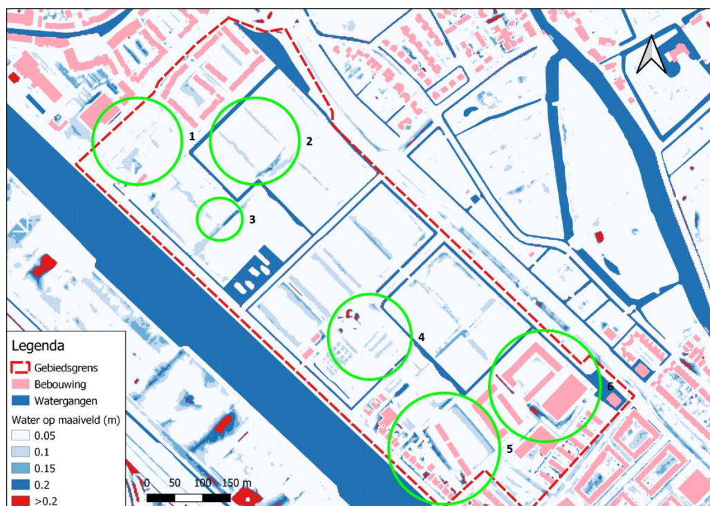
Figuur 6 Maximale waterdieptes op maaiveld in de nieuwe situatie voor het 45mm scenario. De groene cirkels geven gebieden van aandacht aan.
