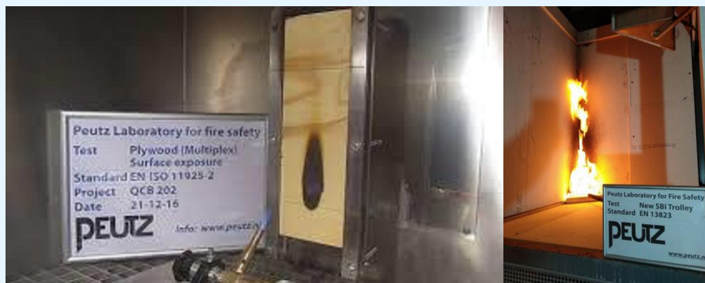
figuur 1: opstelling NEN-EN-ISO 11925-2 (links) en NEN-EN 13823 (rechts)
