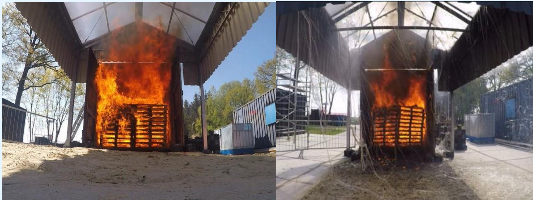
figuur 3: opstelling brandproef afstudeeronderzoek R.G. Booms (bron afstudeerscriptie)
