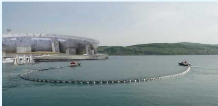
figuur 7674: visualisatie voor de beoogde voorziening om tussen de langsdam en de kade te plaatsen om te voorkomen dat een plasbrand achter de langsdam te dicht bij het stadion komt
