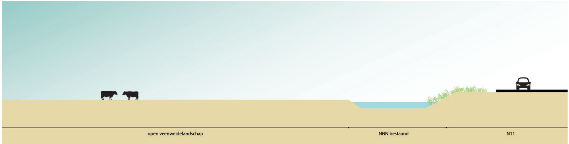
Principedoorsnede 2: bestaande situatie, open weidelandschap, brede watergang, N11 op grondlichaam circa 1m boven maaiveld.
