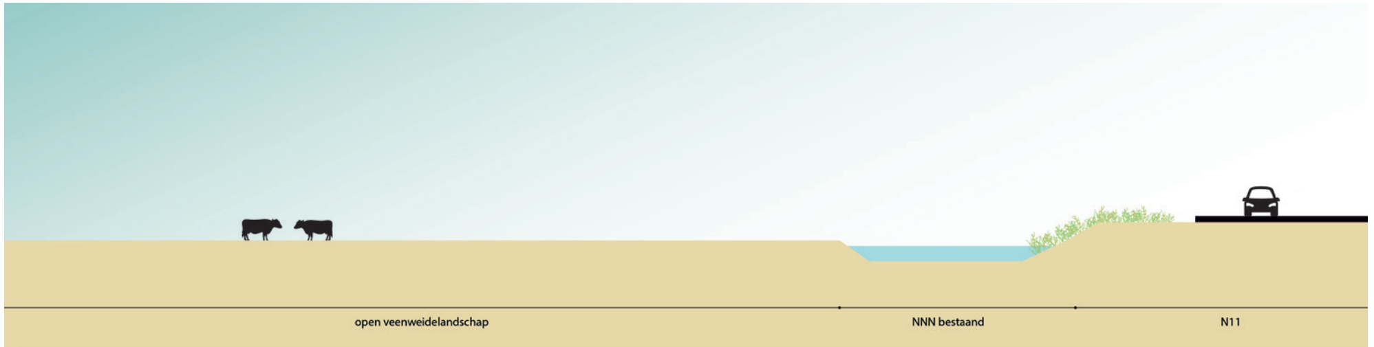
Principedoorsnede 3: bestaande situatie, open weidelandschap, brede watergang, N11 op grondlichaam circa 1m boven maaiveld.
