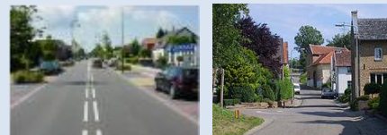
Binnen de bebouwde kom: de gebiedsontsluitingsweg (50 km/u) links en de erftoegangsweg (30 km/u) rechts.
