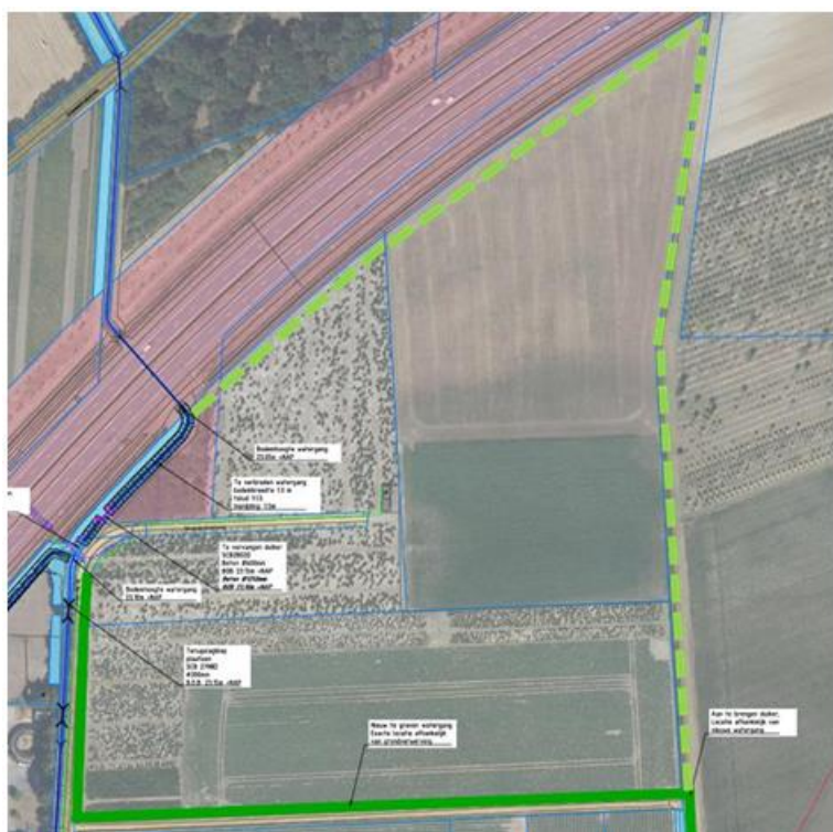
Figuur 3. Nieuwe verbinding tussen de Vuilbeek en de Gansbeek. Het gaat hierbij om de groene stippellijn (de groene lijn komt te vervallen)
