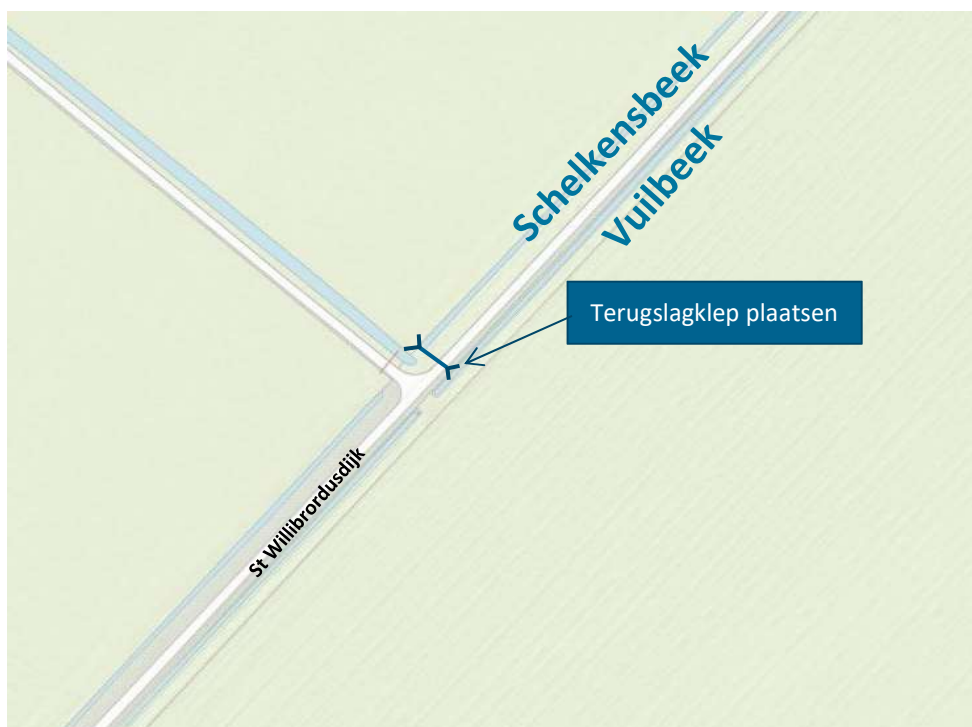
Figuur 2-20, aan te brengen terugslagklep in duiker St. Willibrordusdijk 5
