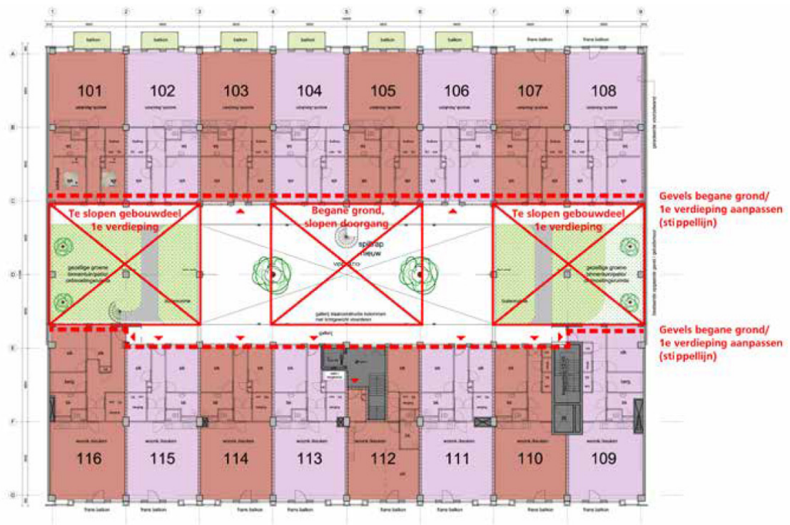
Figuur 3. Overzicht van de te slopen gebouwdelen van het voormalige stadskantoor.
