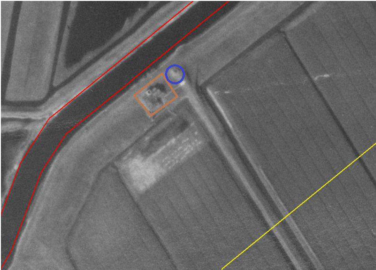
Figuur 7: Uitsnede van luchtfoto 3024-106G/4531 (DOTKA), waarin het bruine kader de Flugmeldepost Wijdewormer afgebakend is. Binnen de blauwe cirkel is het luchtdoelkanon (waarschijnlijk een 20mm Oerlikon luchtdoelkanon) wat bij de post hoorde te zien.
