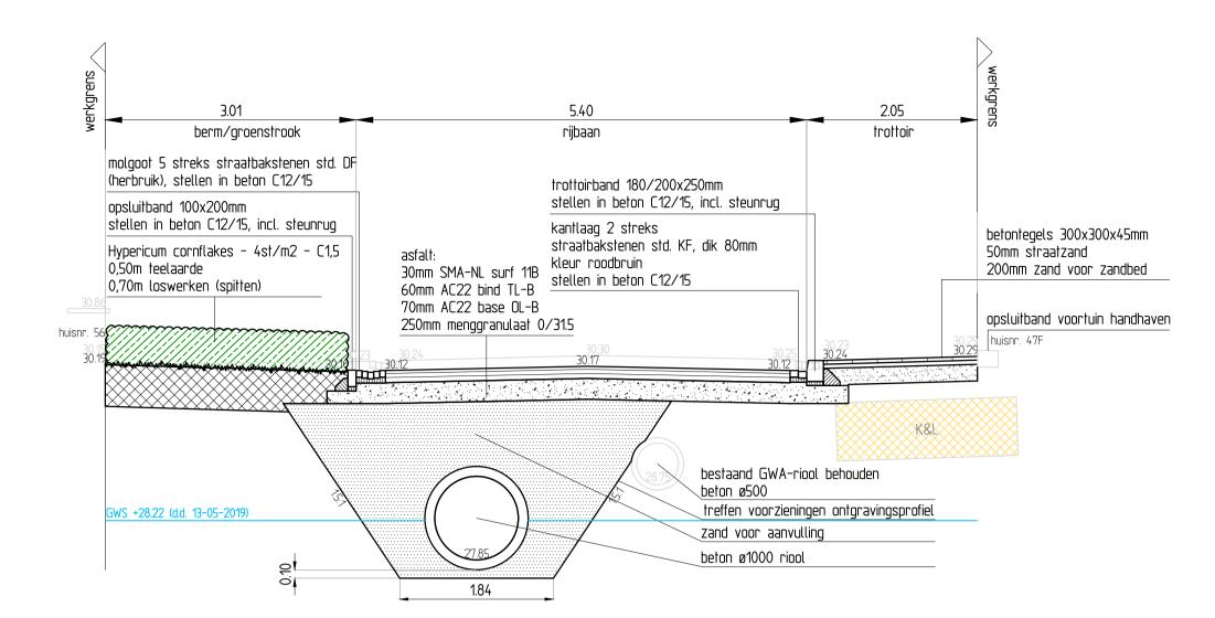
Dwarsprofiel A-A schaal: 1 : 50
