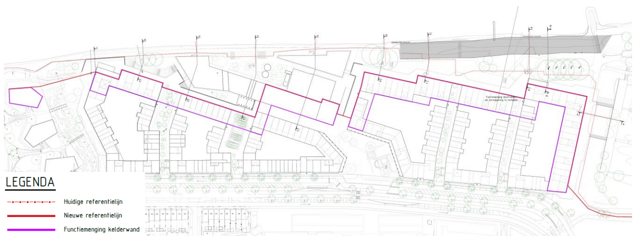
Figuur 4.3: Ligging van de nieuwe waterkering. De rode lijn betreft de toekomstige referentielijn, zoals moet worden opgenomen in de Legger van het waterschap. De paarse lijn is de contour van het deel van de bebouwing die een dubbelfunctie krijgt (zie ook gedetailleerde tekening in Bijlage 1).
