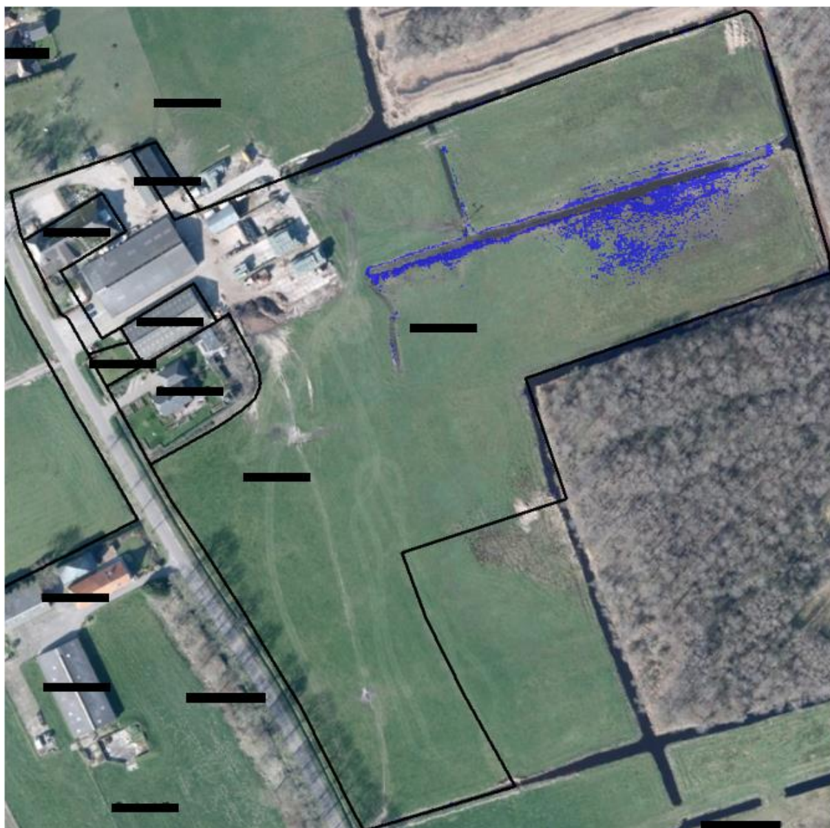
Figuur 4: Inundatie bij NAP -0,83 m (inundatie 0,12 ha).
