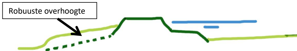
Figuur 7 - Pipingberm met robuuste overhoogte
