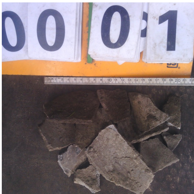
Asbestverdacht materiaal sleuf 01
