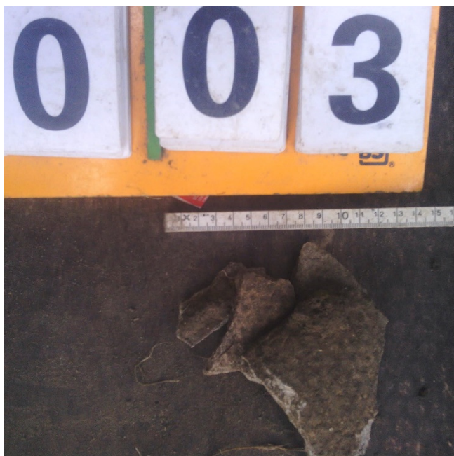
Asbestverdacht materiaal sleuf 03
