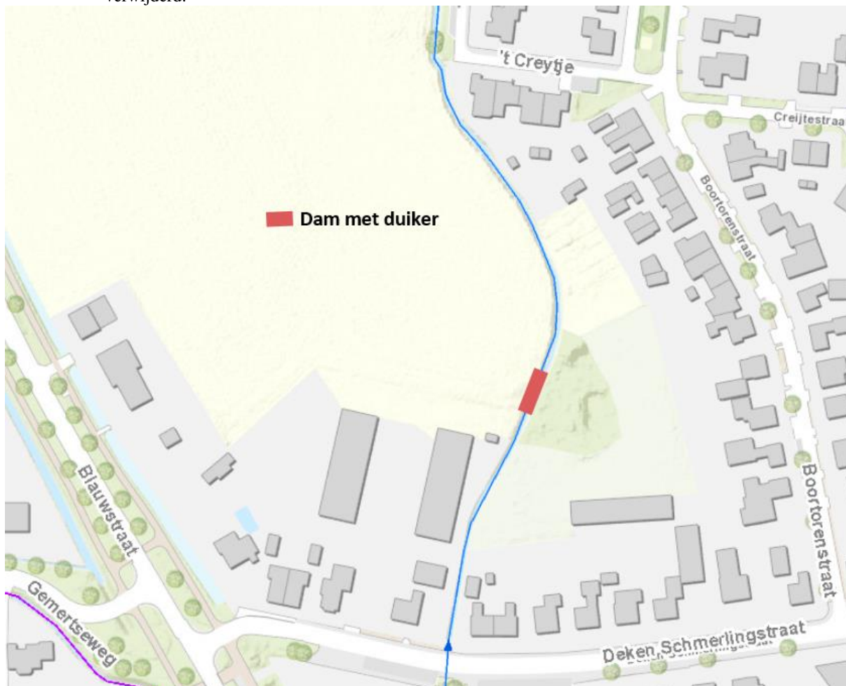
Afbeelding 2: Te realiseren dam met duiker
