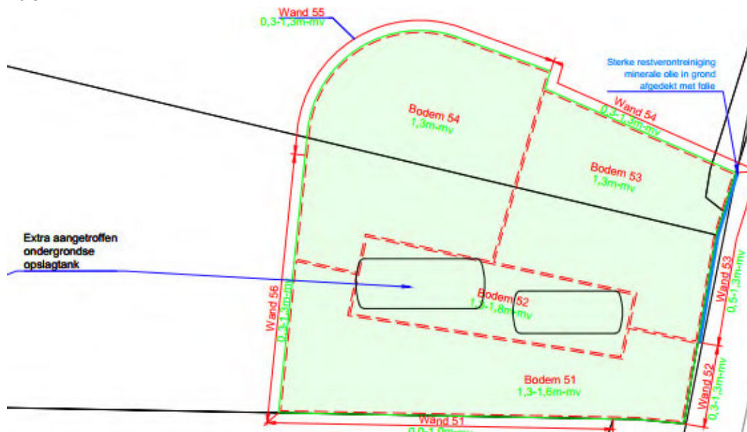
Figuur 2: Kaartfragment situatietekening BUS-evaluatie met ontgravingscontour uitgevoerde BUS-sanering met de ligging van de twee extra aangetroffen tanks.
