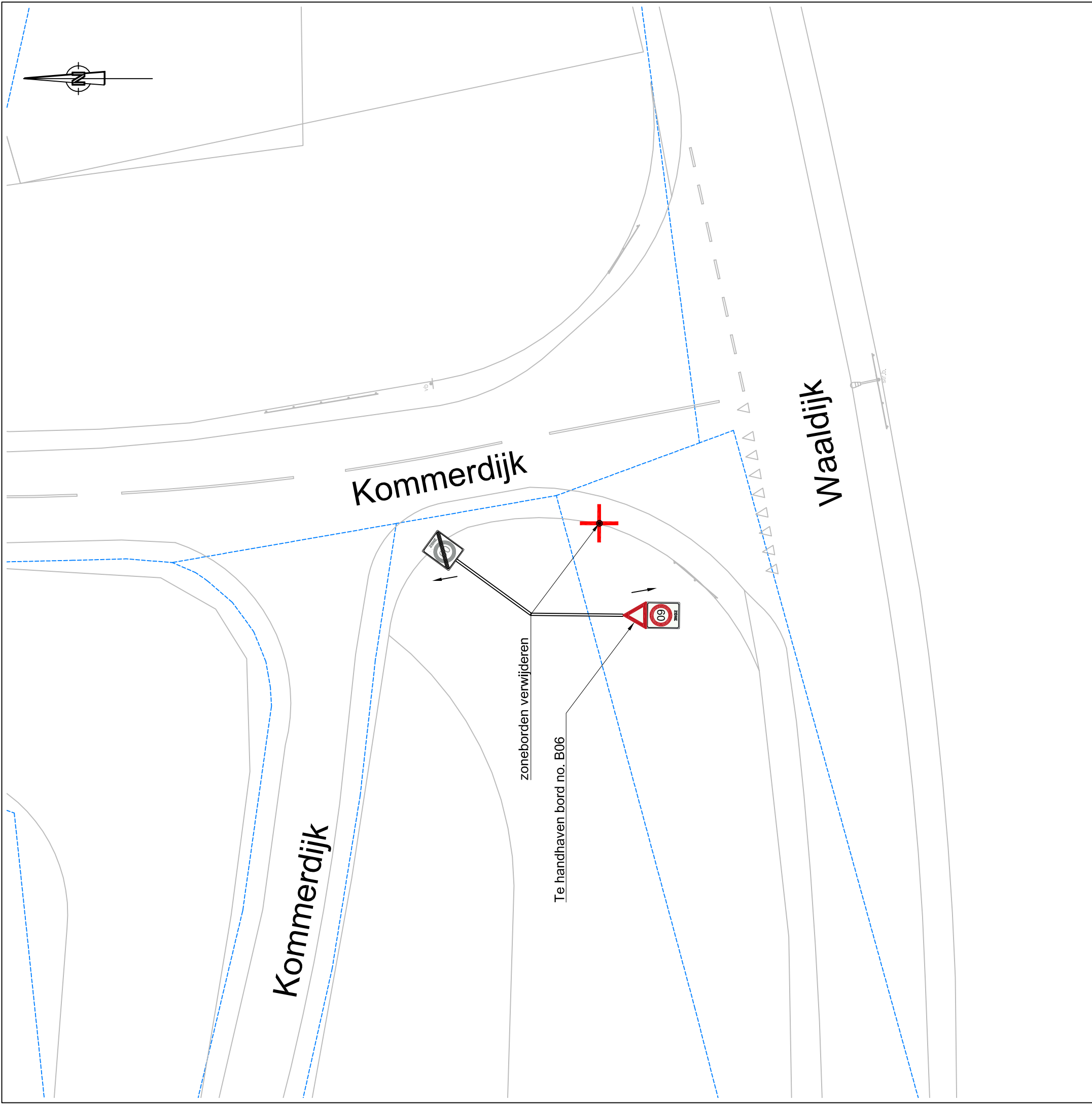
6. Verwijderen zone bebording Kommerdijk - Waaldijk
