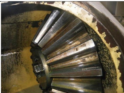
Detailfoto 10: Schade tandwiel uitgaande as HTK 1
