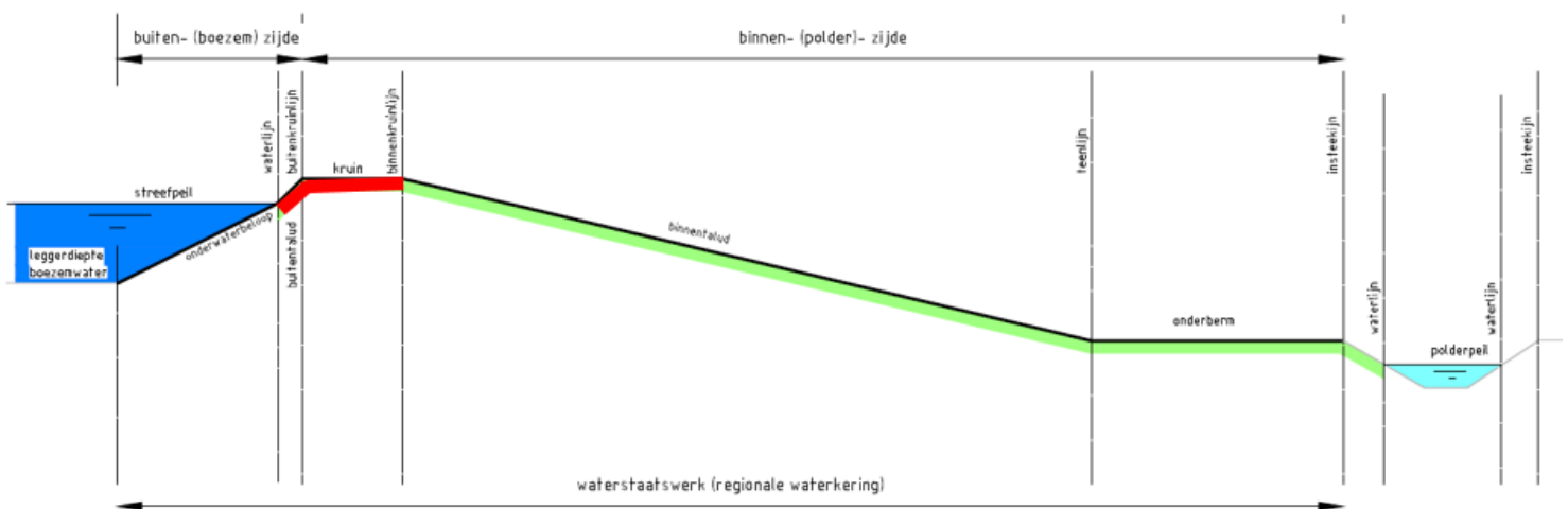
Figuur 2: Zone beoordeling lekkage door wortels (rode zone = gevaar voor waterstaatswerk)
