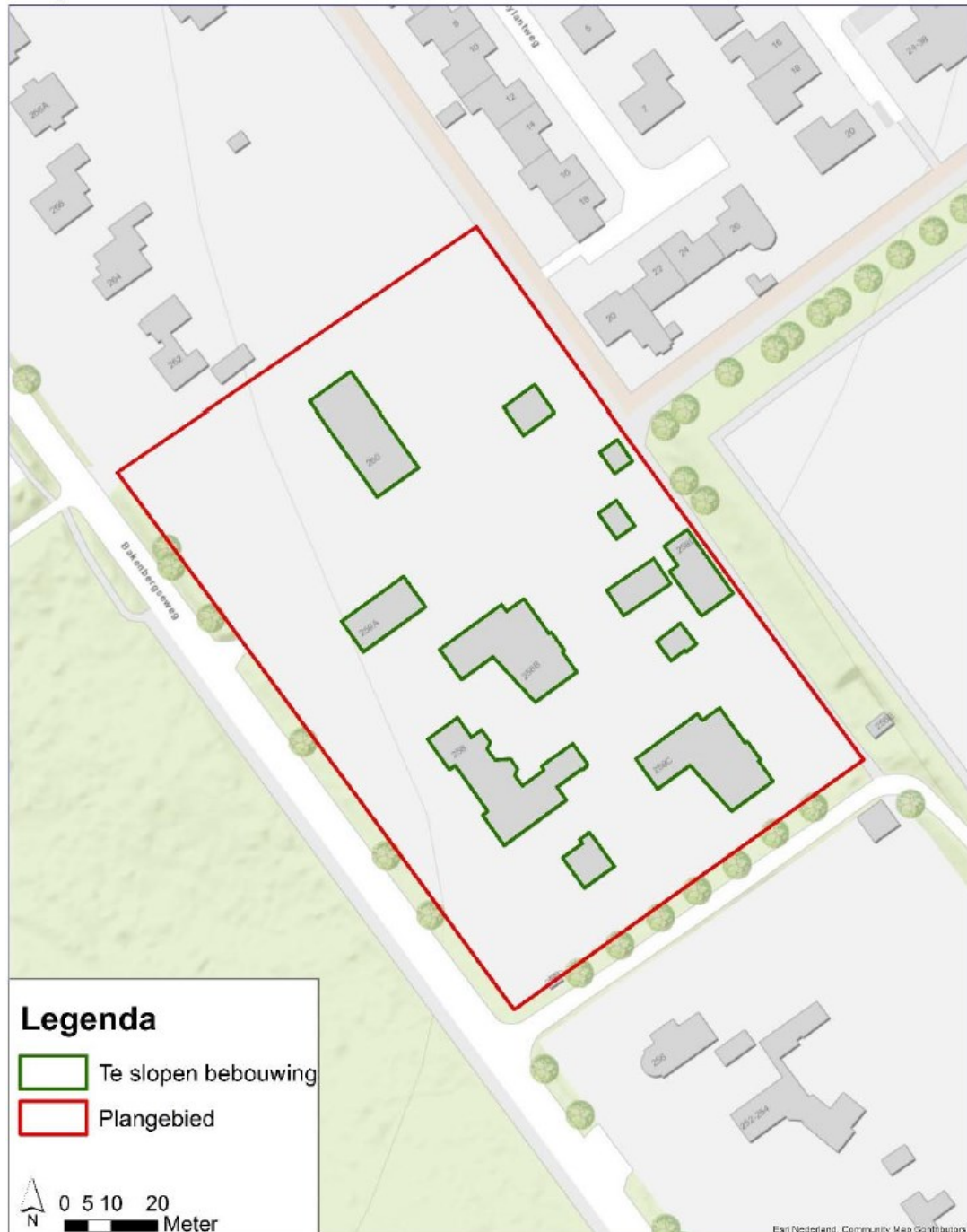
Figuur 3. Begrenzing locatie Bakenbergseweg en overzicht van de te slopen bebouwing
