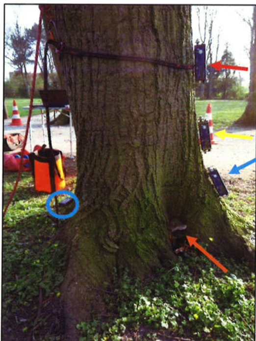
Foto 6: Links een beeld van de stam met sensoren, het vruchtlichaam is met een oranje pijl aangeduid. De inclinometers zijn met een cirkel en de elastometers met een pijl aangeduid. De kleuren corresponderen met de kleurcode in tabel 4. Rechts een beeld van de spechtengaten (gele pijlen).
